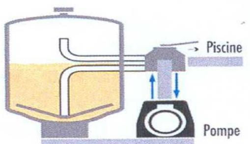
**C'est la position de la vanne multivoies qui permet de faire circuler l'eau sans passer par le filtre à sable.** L'eau passe dans la pompe puis retourne dans la piscine via les buses de refoulement.
